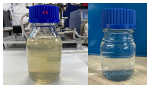
Figure 4. a) Tb x Dy 1-x Fe 2 nanoparticles. b) TiO 2 nanoparticles
